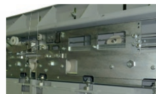
Türblattaufhängung Musterbeispiel Industrietür
