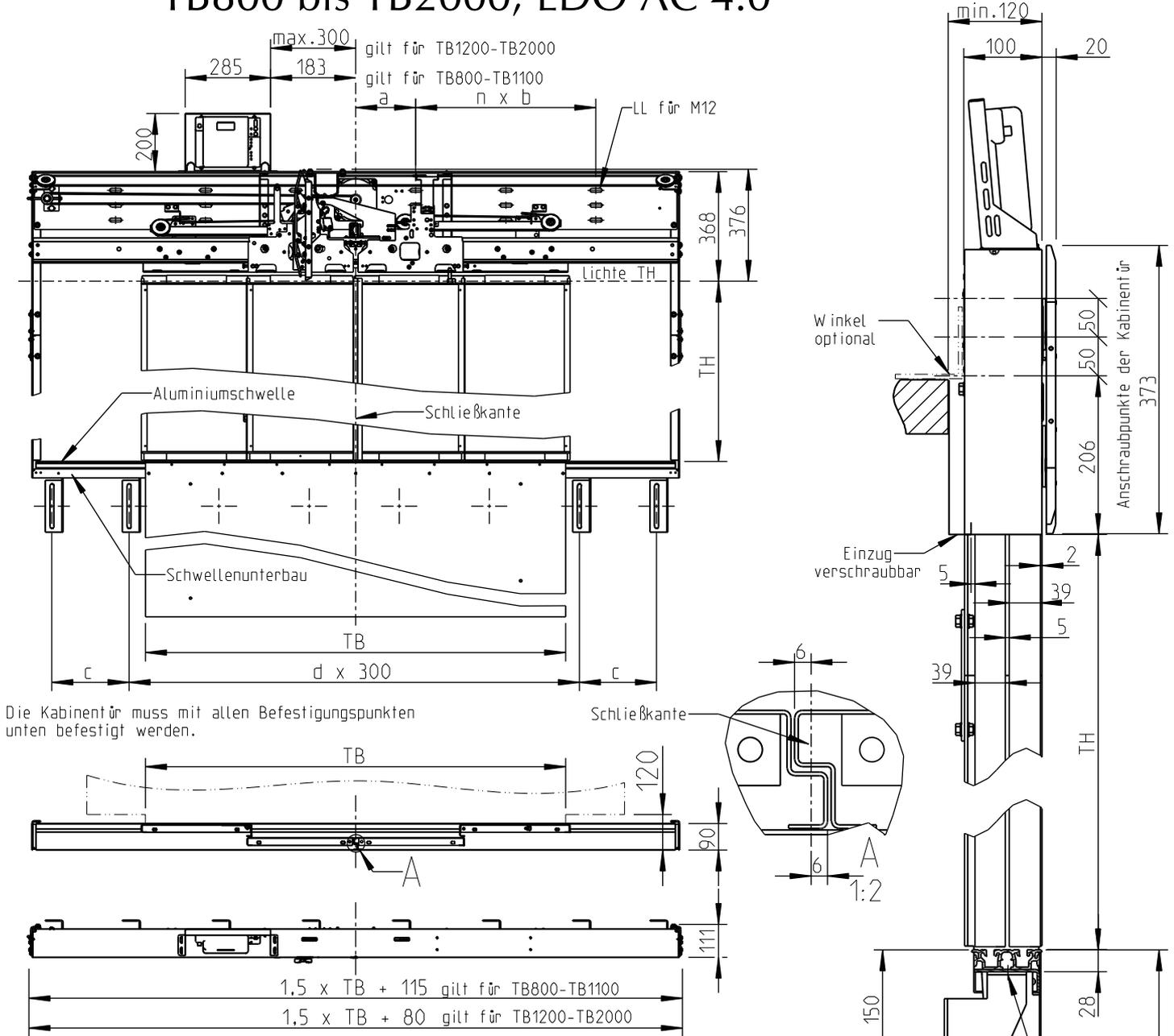
Die Kabinentür muss mit allen Befestigungspunkten unten befestigt werden.
