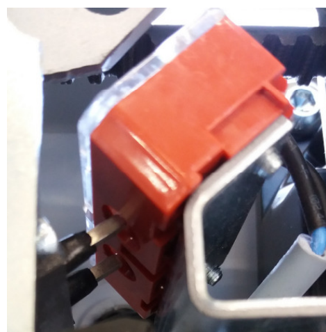
Bild 8: mittiger Eingriff der Brücke
