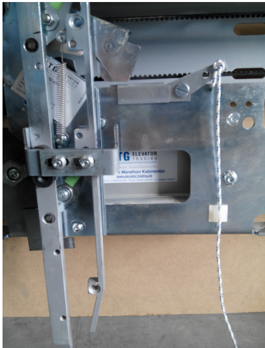
Bild 22: Entriegelung der KTV G1
