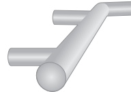
Handlauf umlaufend im Eck auf Gehrung, Ø35 oder Ø40mm
