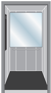
Miroir VSG 6 mm cristal collé sur paroi, à mi-hauteur
