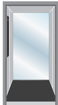
Miroir VSG 6 mm cristal collé sur paroi, toute hauteur
