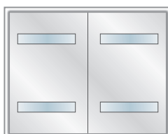
faux-plafond suspendue en deux parties, surface lumineuse 4x 150 x 850 mm avec lumière surfacique LED
