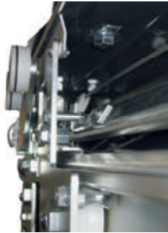
Verstärkte Fahrschlitten mit Rückhalteeinrichtung an der Sicherungsschiene
