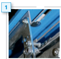
1 Verstärkte Fahrschlitten mit Rückhalteeinrichtung an der Sicherungsschiene
