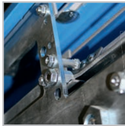
Förstärkt vagn med tippskyddsplåt mellan vagnen och toptrackens överdel
